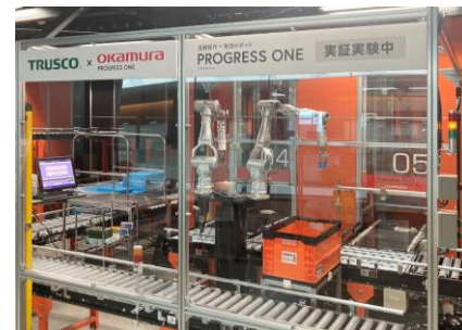
ピッキングロボットを設置した専用ポート
