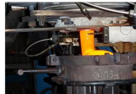
溶融ガラスを金型に供給する様子
