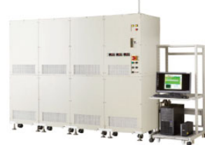
充放電試験システム
