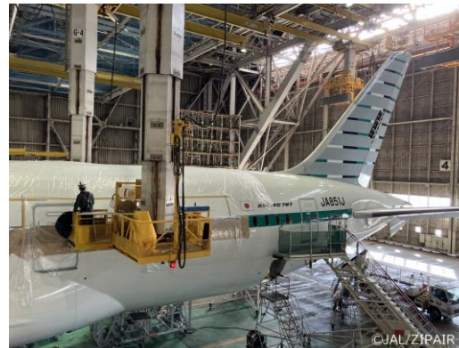
リブレット施工作業風景
