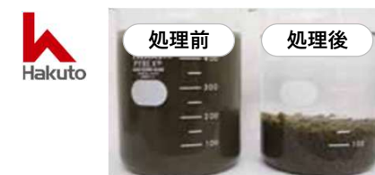
独自の排水処理用薬剤「ハクトロン」を一次処理に使用。蒸留装置の運用効率が向上
