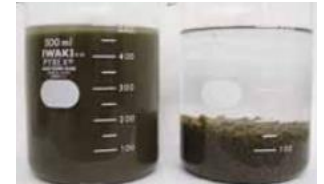
伯東独自の排水処理用薬剤「ハクトロン」は汚染水の一次処理に使用することで、蒸留装置の運用効率が向上(写真左から処理前、処理後)
