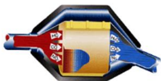
⑤浄化 排気管
