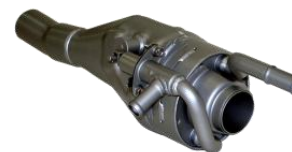
⑦熱マネ 排気熱回収器
