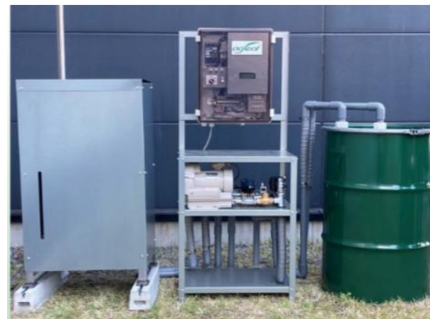
▲ 農業ハウス栽培用CO2貯留・供給装置「agleaf®」
