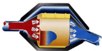
⑤浄化 排気管
