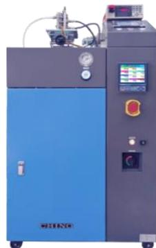
水を水素と酸素に電気分解して、効率よく水素を取り出せるかを評価する装置
