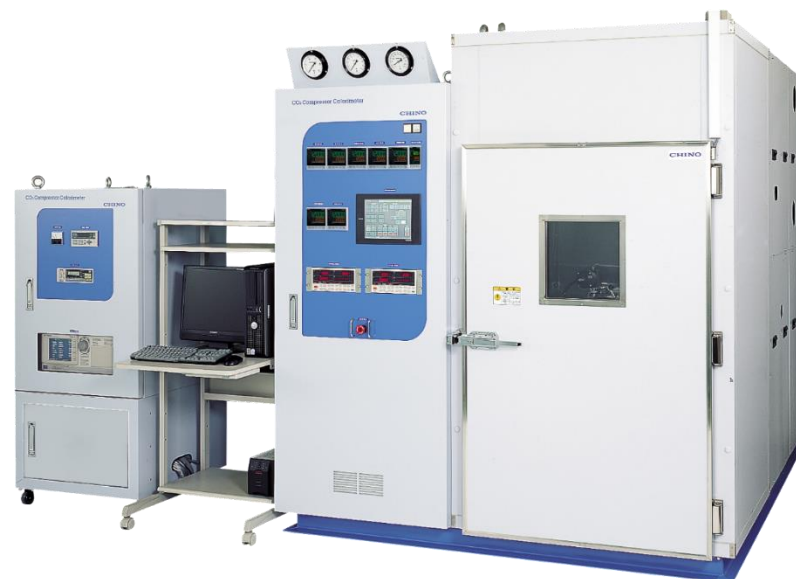
コンプレッサ性能試験装置
