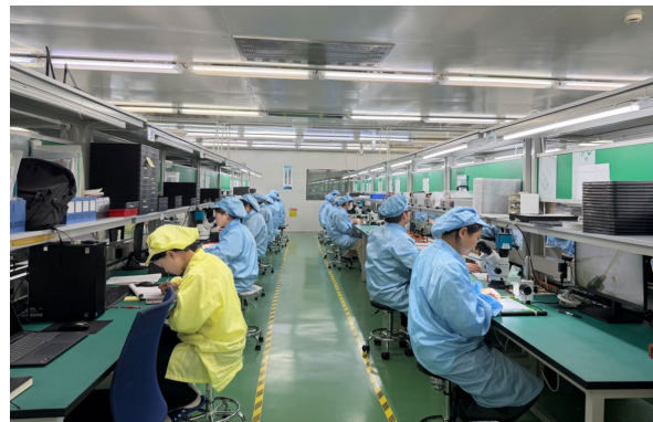
精工訊捷光電ではクリーンルーム内でMTファイバアレイを量産
