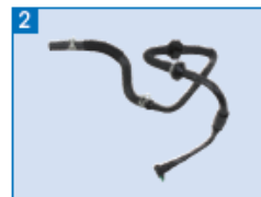
ブレーキバキューム配管
