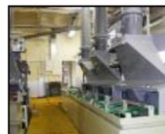
■ 前洗浄からメッキ処理工程までの一貫生産が可能だが、処理槽のサイズが小さくエンジンバルブを処理出来ない為、設備投資し、エンジンバルブへの**粗メッキ処理を内製化**する。
