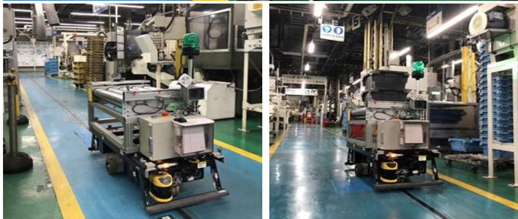
加工ライン⇒表面検査工程へAGVを活用
