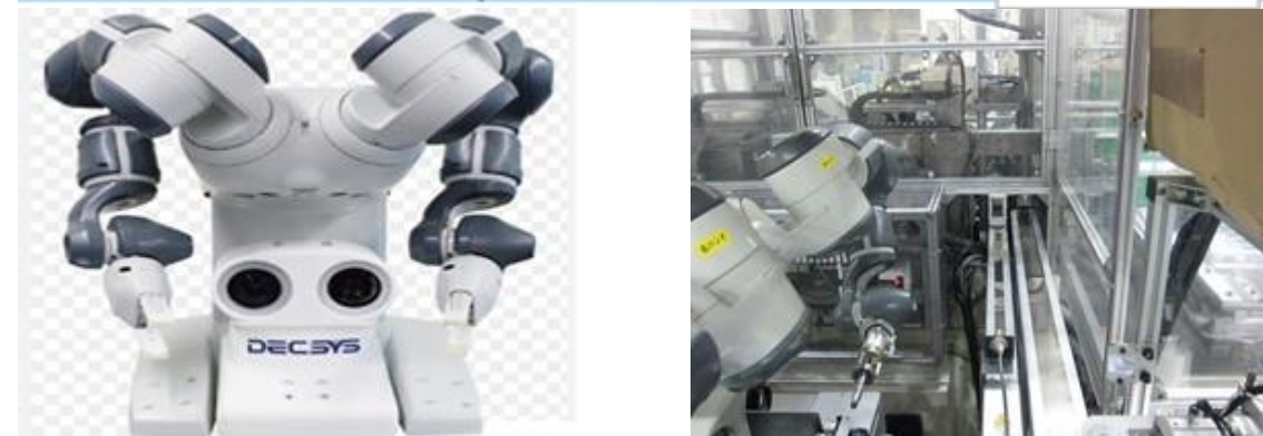
PBWピストンのバリ取り後品質確認に双腕画像検査機「外観けんた君（株式会社デクシス社製）」を活用
