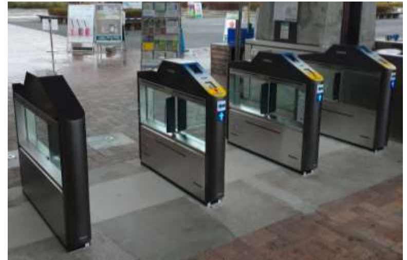
公園の入退場システム (QR・ICカードに対応しています)
