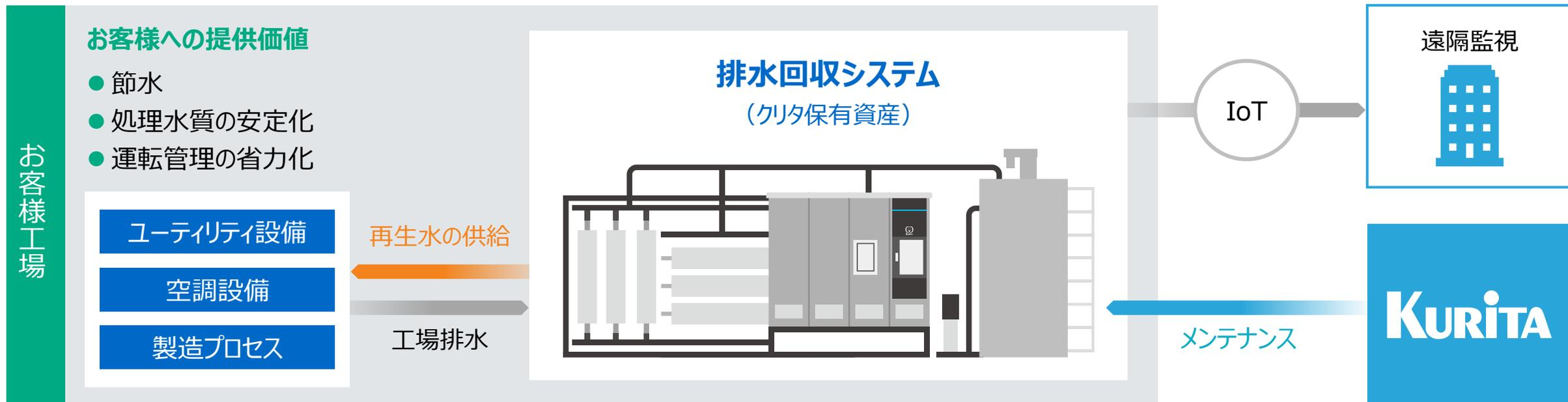
大手電子部品製造のお客様工場では、**上水使用量・コスト約8割減、下水コスト約3割減** (従来比)
