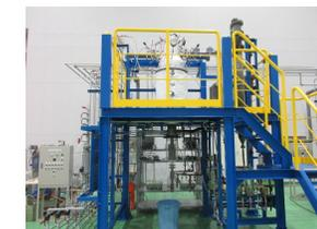
アンモニア燃焼用テスト機
