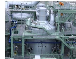
過給式流動燃焼システム
