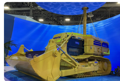
水中施工ロボット
