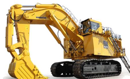
超大型油圧ショベル
