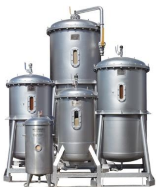
排水処理装置
