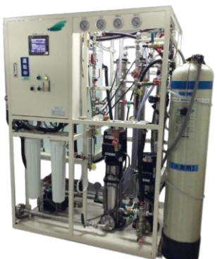
純水製造装置
