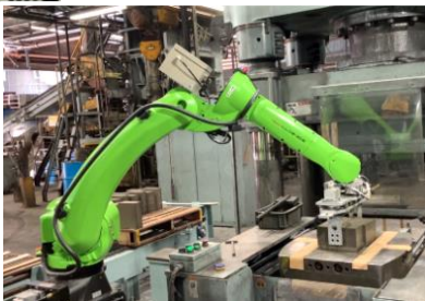
協働ロボットを活用した 成形工程 (日生工場)
