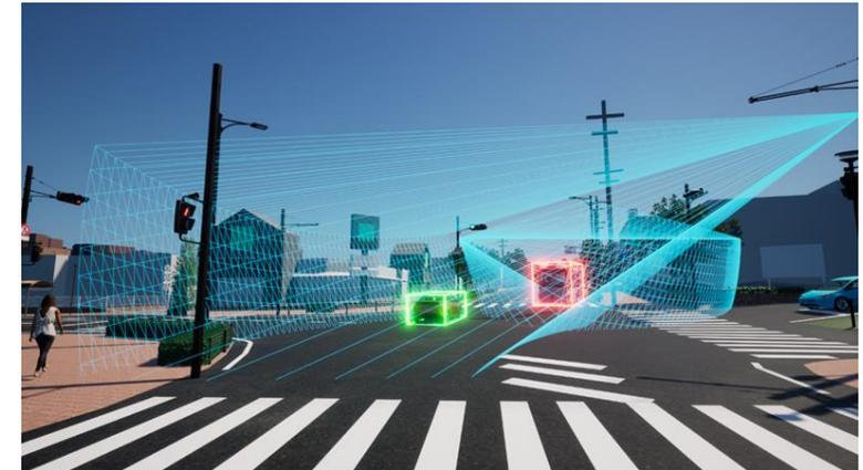
WARXSSは自動運転車両のソフトウェアと公道環境のシミュレータを繋ぎ合わせて、動作の安全性を確認できるツール。公道を走らせる前に、安全性テストを実施できる。
