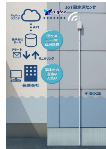
IoT 浸水深センサシステムのイメージ
