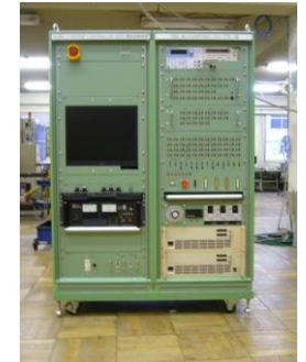
飛翔体 E/C 機能試験装置
