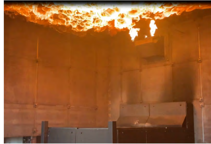
火炎のロールオーバー
