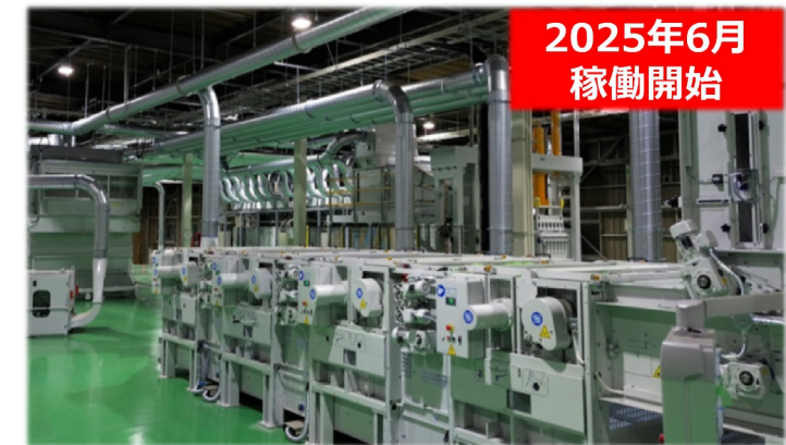
反毛リサイクル設備（FANS：石岡工場）
