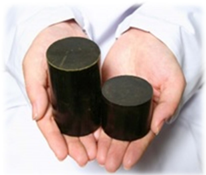
↑ コーヒーグラウンズ等から作るバイオマス燃料 (バイオコークス)
