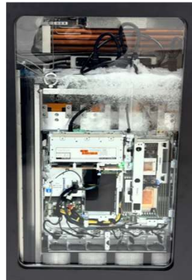
▲ 液浸冷却装置
