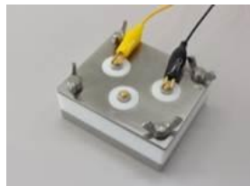
試験用マグネシウム蓄電池セル
